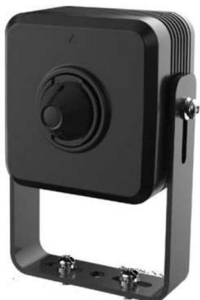
Telecamera IP miniaturizzata da interno con sensore CMOS progressivo 1/2.7" da 2Mp, risoluzione 1080p con 25Fps, ottica fissa pinhole da 2.8mm, luminosità 0.007Lux f2.4, porta LAN 10/100, 1 ingresso e 1 uscita audio, privacy mask 4 aree, 3D, WDR (120dB), alimentazione 12Vdc <1.5W, in dotazione staffa di fissaggio
